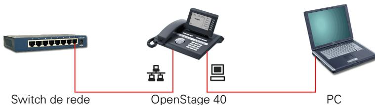
➡ Para ligar o OpenStage 40 a um PC necessita apenas de um cabo de rede do tipo normal (não utilizar cabo cruzado).
