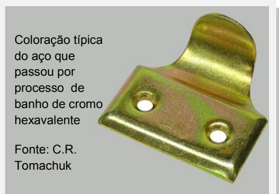
Coloração típica do aço que passou por processo de banho de cromo hexavalente
